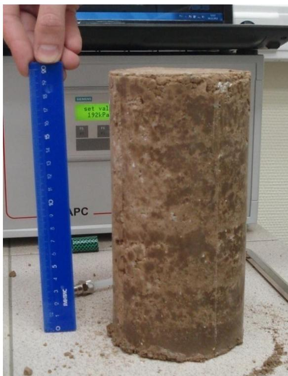
*Рис. 5.7. Готовый образец грунта*
