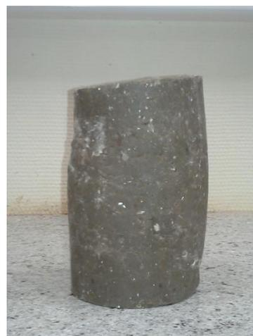
*Рис. 5.9. Фотографии разрушенных образцов грунта тела плотины Рогунской ГЭС*
